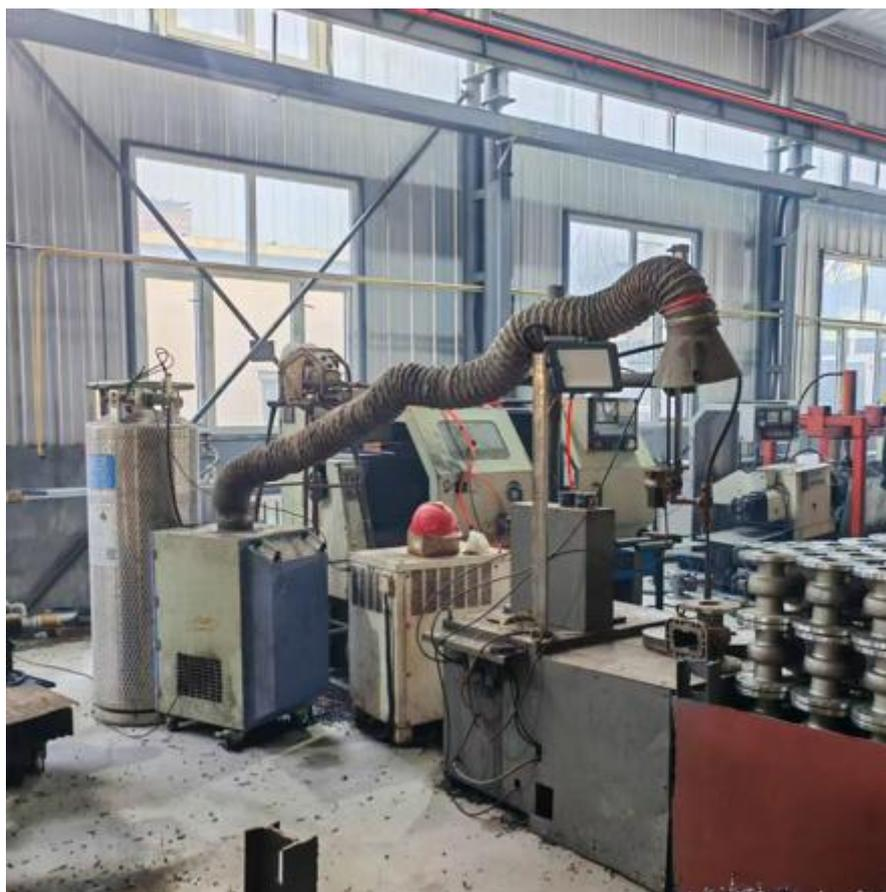
图 3-2 项目移动式焊烟除尘器照片
